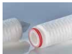
Codice 7: aperto da un lato (SOE), 2-226 o-ring adattatore a baionetta doppia con punta di centraggio, diametro esterno 56 mm (parte più in basso)
