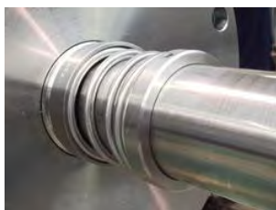
Tenuta meccanica interna al processo, senza campana
